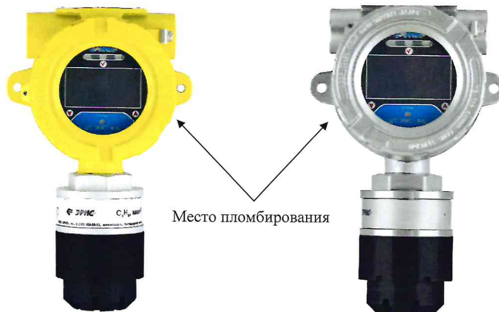
Рисунок 3 - Общий вид газоанализатора ДГС ЭРИС-ФИД-02 в алюминиевом корпусе и схема пломбировки от несанкционированного досту-
