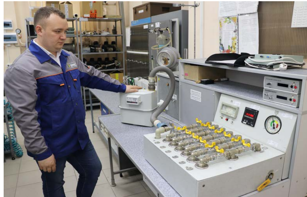
Газовая поверочная установка УПРС-16
