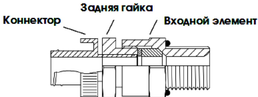
Рисунок – 20 Кабельный ввод
