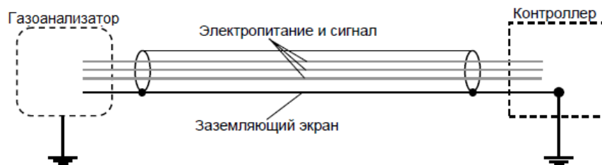
Рисунок 13 – Заземление экранированного кабеля
