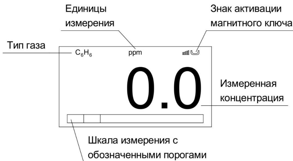
Рисунок 6 – Описание информации на OLED дисплее
