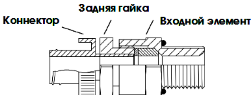
Рисунок – 16 Кабельный ввод
