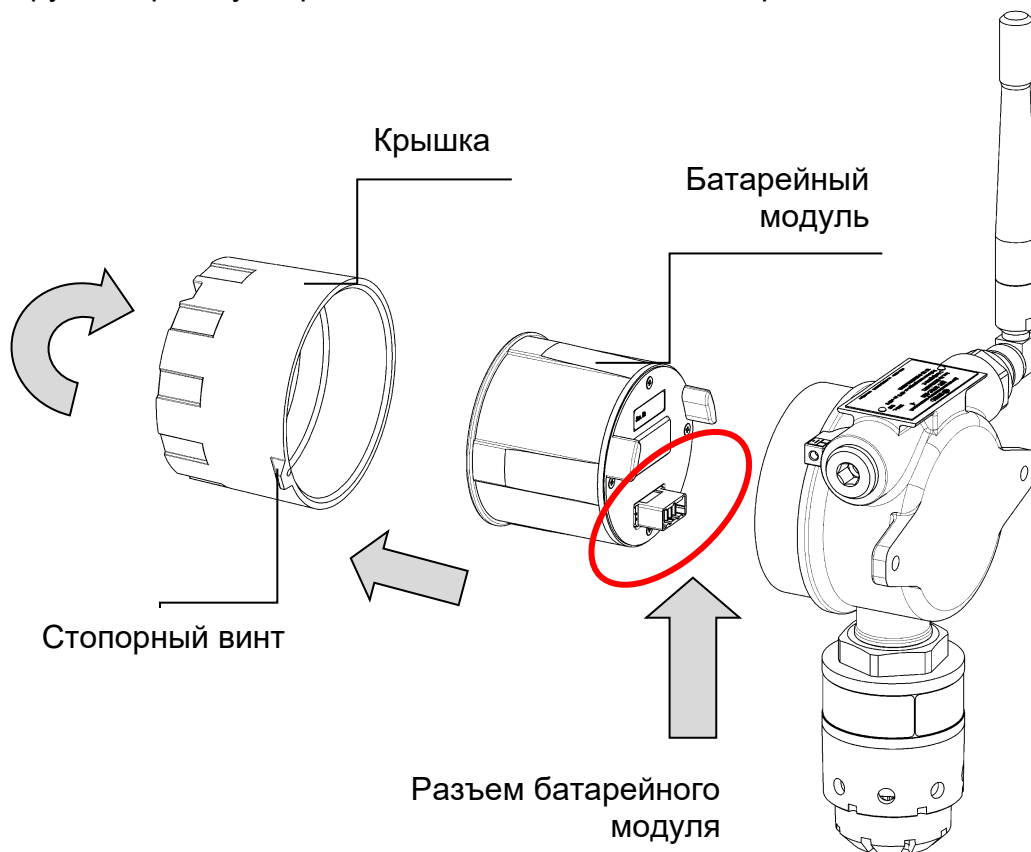
Рисунок 32 - Схема разбора газоанализатора для активации (вид сзади)
