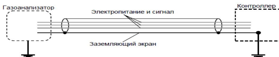
21 – Заземление экранированного кабеля
