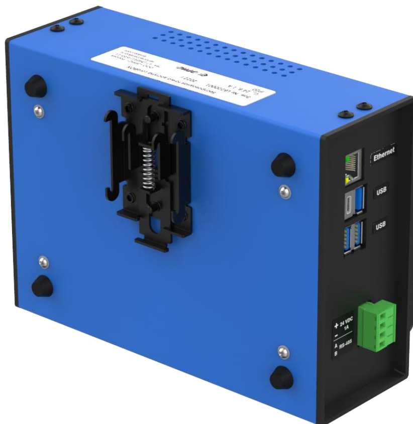
Рисунок 5 – Крепление LoraBOX на DIN-рейку
