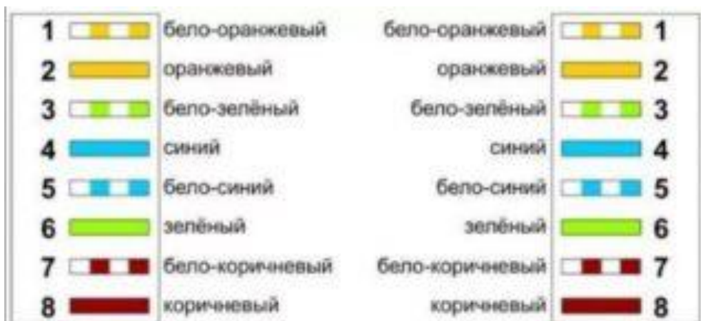
Рисунок В.1 – Разводка сетевого кабеля
