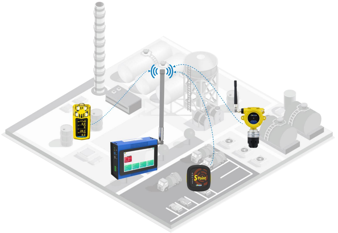
Рисунок 1 – Схема взаимодействия LoRaBOX и устройств сопряжения
