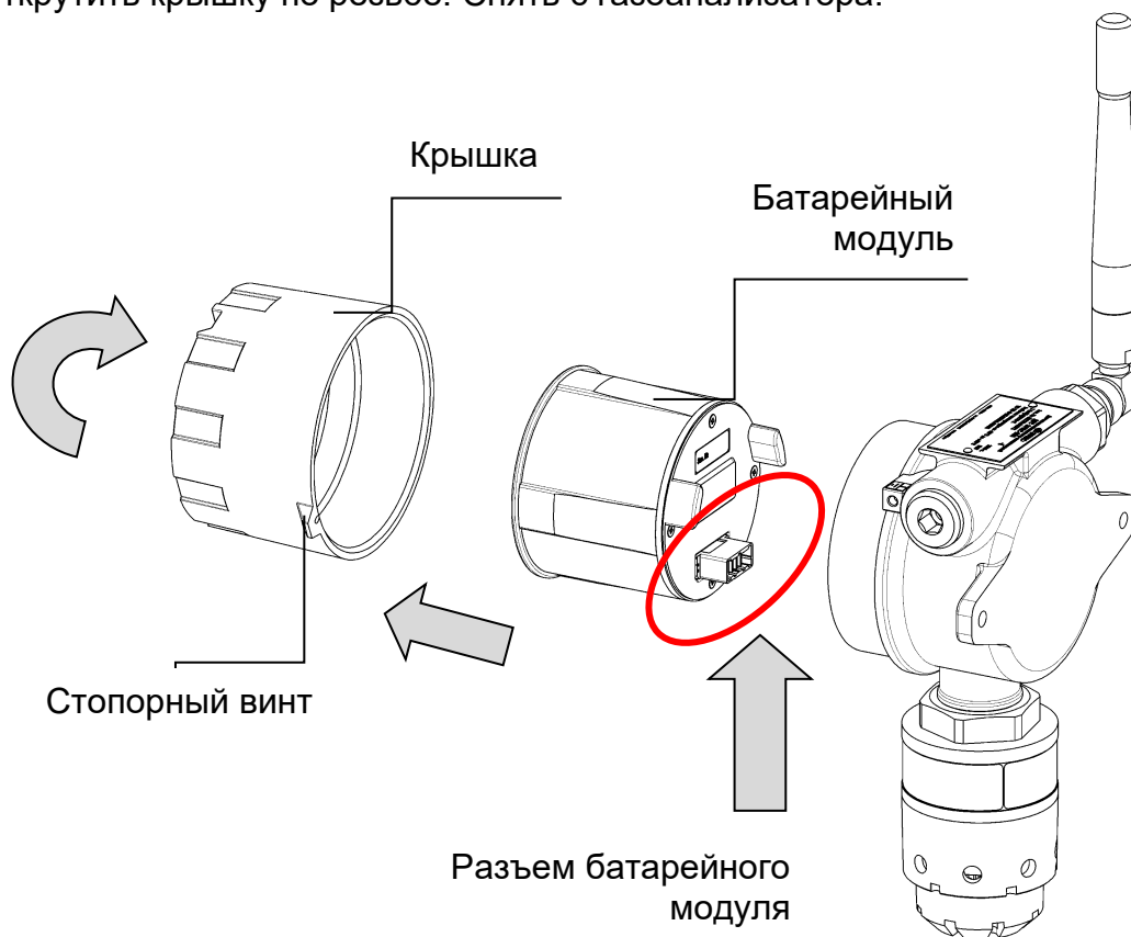
Рисунок 20- Схема разбора газоанализатора для активации (вид сзади)
