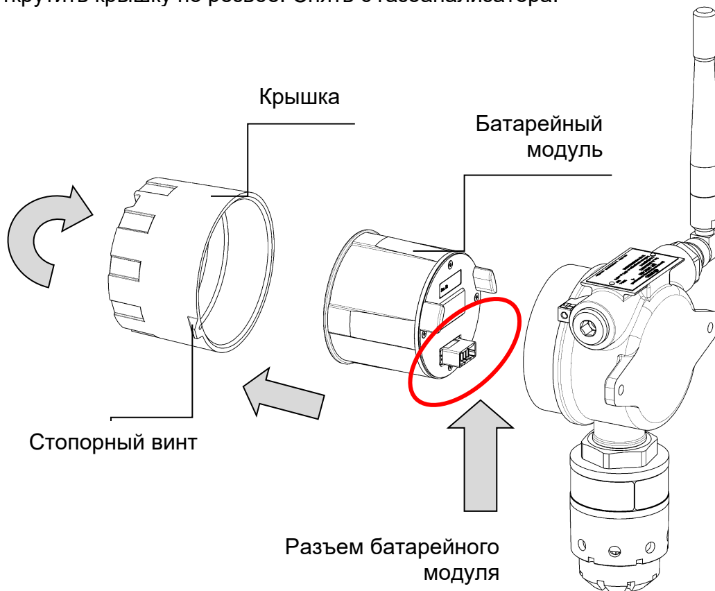
Рисунок 20- Схема разбора газоанализатора для активации (вид сзади)
