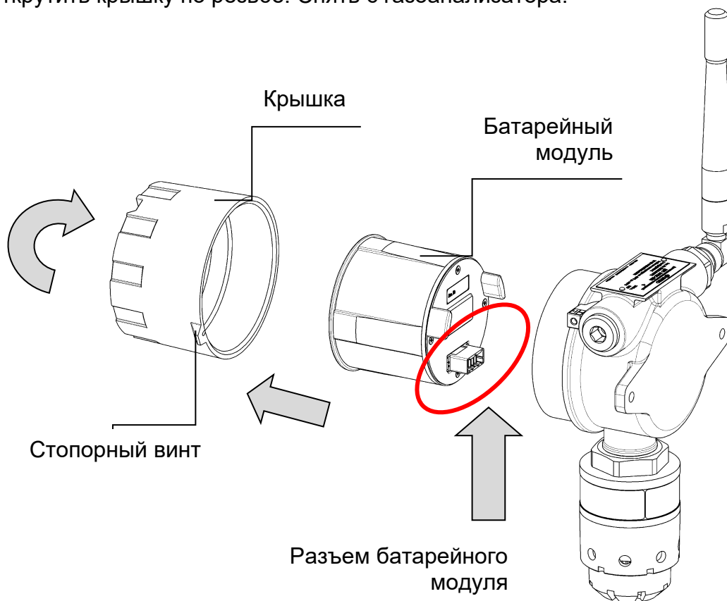
Рисунок 20- Схема разбора газоанализатора для активации (вид сзади)
