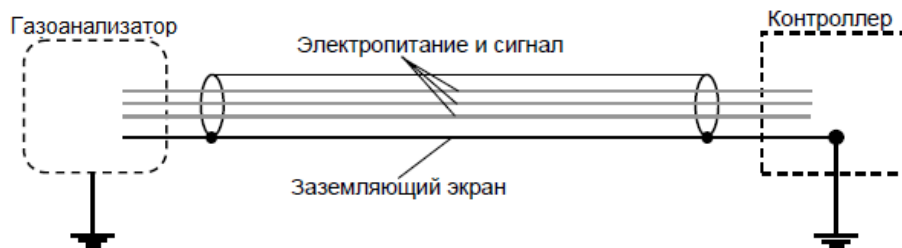
Рисунок 21 – Заземление экранированного кабеля
