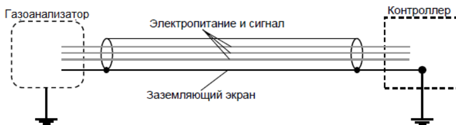
Рисунок 20 – Заземление экранированного кабеля
