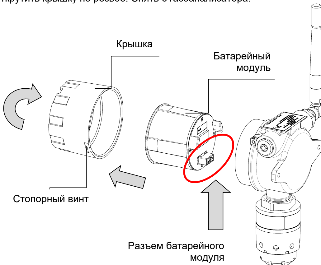
Рисунок 20- Схема разбора газоанализатора для активации (вид сзади)
